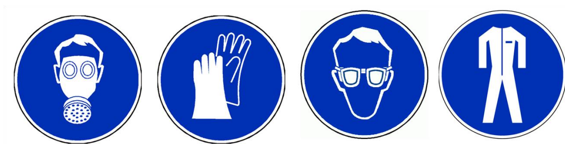
Abbildung 1: Wichtige Gebotszeichen für einen sicheren Umgang mit synthetischen Nanomaterialien am Arbeitsplatz: Atemschutz, Schutzhandschuhe, Schutzbrille, Schutzbekleidung (v.l.n.r.).
